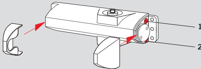
Die **Schließgeschwindigkeit** des DORMA TS 90 Impulse ist über Ventile in zwei voneinander unabhängigen Bereichen stufenlos einstellbar.
