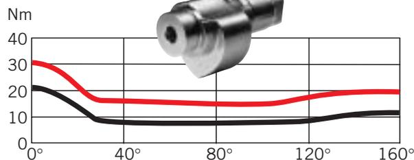
Die herzförmige Nockenscheibe und der Lineartrieb des DORMA TS 90 Impulse sorgen für eine leichte Betätigung der Tür durch ein stark abfallendes Öffnungsmoment. So haben selbst Kinder, alte Menschen und Behinderte keine Mühe mehr, Türen zu öffnen.
